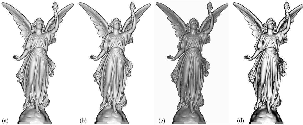
FIG. 4.6: Résultat produit par l'EDL en monorésolution, et pour différents calculs de s(p, q) . (a) Fonction de base : s(p, q) = [(z_q - z_p)/d_{pq}]^+ . (b) Calcul d'un pseudo-angle, le résultat obtenu est quasiment identique : s(p, q) = [\arctan(z_q - z_p)/d_{pq}]^+ . (c) s(p, q) = \sqrt{[z_q - z_p]^+}/d_{pq} . (d) s(p, q) = ([z_q - z_p]^+)^2/d_{pq} . Les modifications non linéaires du champ de hauteur en (c) et (d) modifient fortement les contrastes dans l'image en fonction des différences locales de hauteur.
