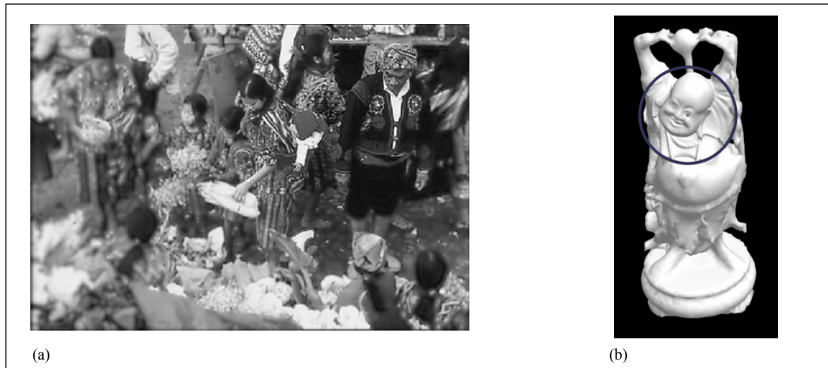
FIG. 2.5: Exemples d'affichages dépendant du regard (GCD, Gaze Contingent Displays ). (a) Tiré de Loschky et McConkie [LM05]. Le niveau de flou dans l'image varie radialement à partir d'un point situé en haut à droite de l'image. (b) Le maillage en pleine résolution (1,5 millions de triangles) est rendu seulement là où l'utilisateur regarde, ce qui est matérialisé par l'anneau bleu, et une version simplifiée (15000 triangles) est affichée en périphérie.
