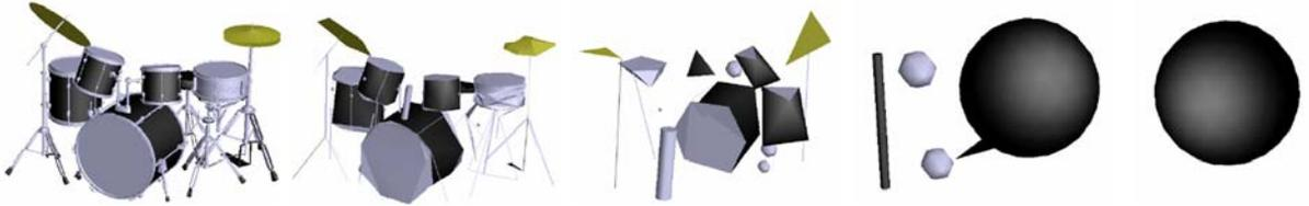
**FIG. 2.5:** Illustration de l'article [PH97]. Représentation progressive de complexes simpliciaux. Les 0-simplexes sont représentés par des sphères, les 1-simplexes par des cylindres et les 2-simplexes par des triangles. Cette représentation ne tient pas compte de la topologie du maillage lors de la simplification.
